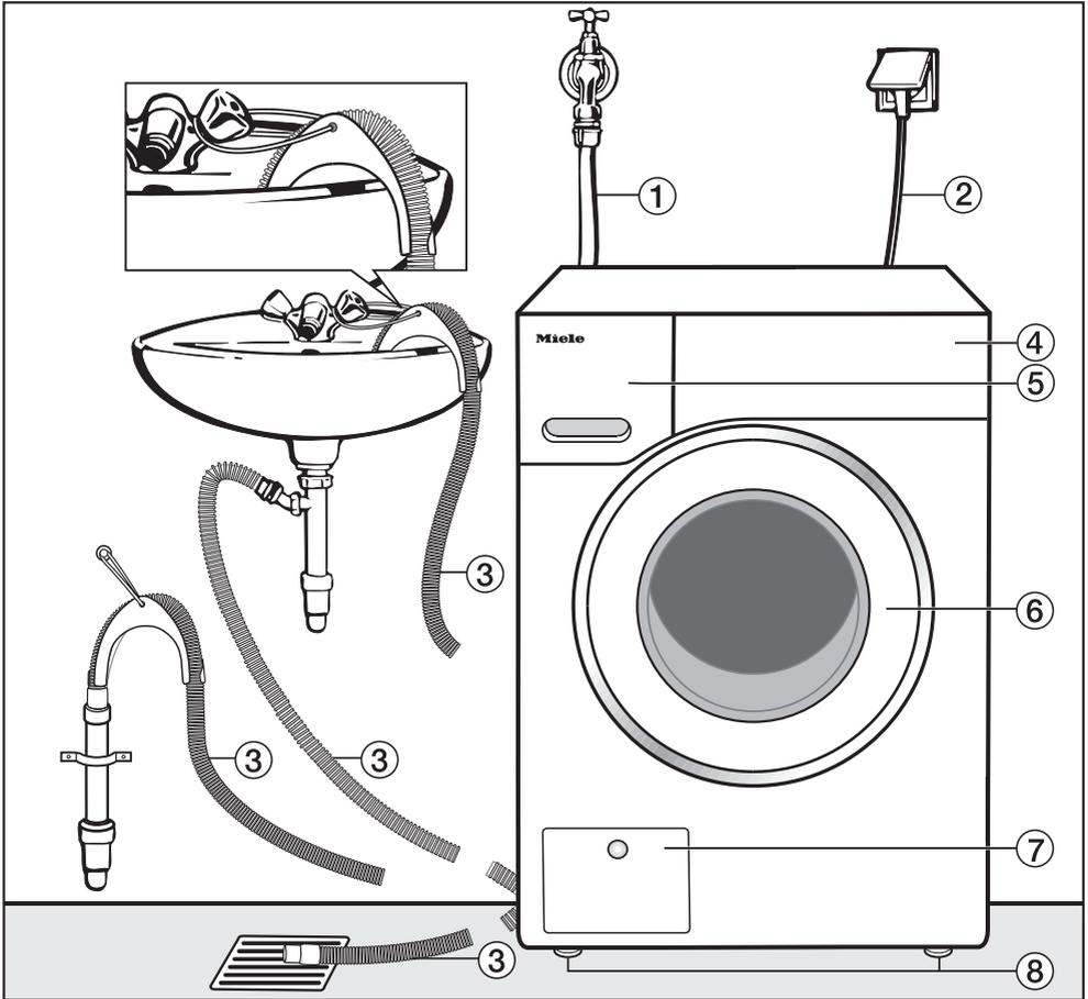
① Wasserzulaufschlauch (druckfest bis 7.000 kPa)
