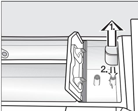
1. Saugheber aus der Kammer
